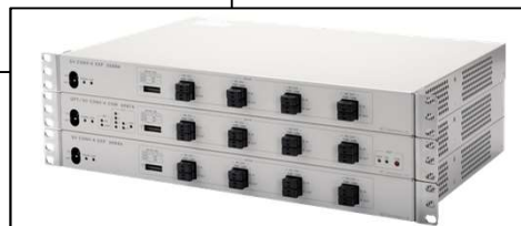
X. 21インタフェース1回線、アナログインタフェース12回線の場合の構成
